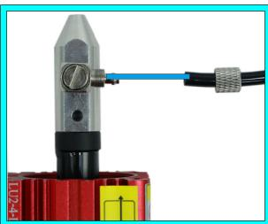
Entfernen Sie die Mutter, führen Sie das Luftrohr nach unten ein und bringen Sie die Mutter wieder an, um sie zu befestigen.
