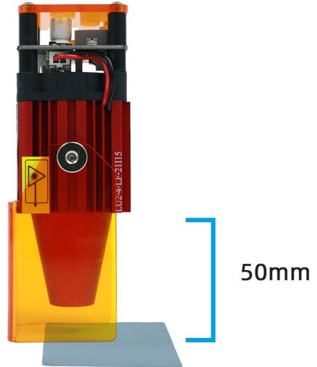
Faites glisser vers le haut et vers le bas pour régler la mise au point, trouvez la position du plus petit point lumineux (un léger bip apparaît) et le point lumineux clignotant apparaît comme indiqué sur la figure.
