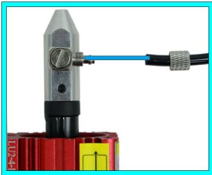
Retirez l'écrou, insérez le tuyau d'air vers le bas, puis réinstallez l'écrou pour le fixer.
