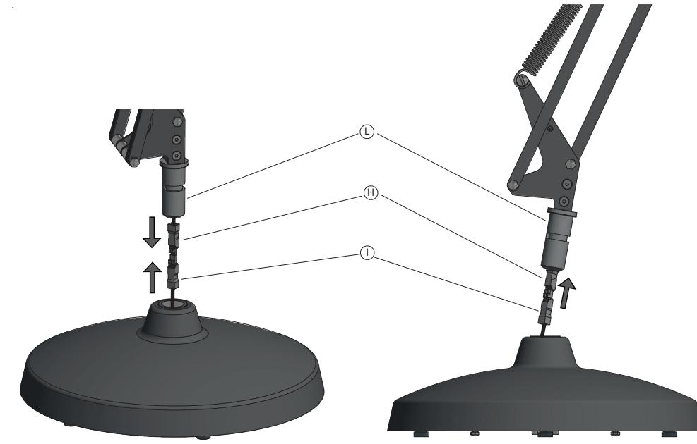
9 - Posizionare il codolo (L) allineando l'apertura (M) sul codolo al perno interno (N) quindi inserire fino in fondo il braccio nella base. Il braccio deve inserirsi fino in fondo.
