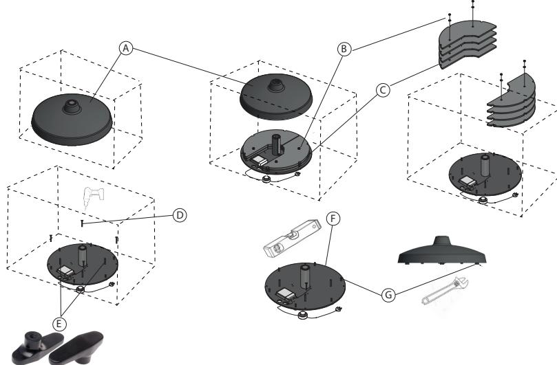
6 - Riposizionare e inserire nei 4 perni filettati (E) le zavorre, e fissarle mediante le 4 viti e le relative rondelle.
