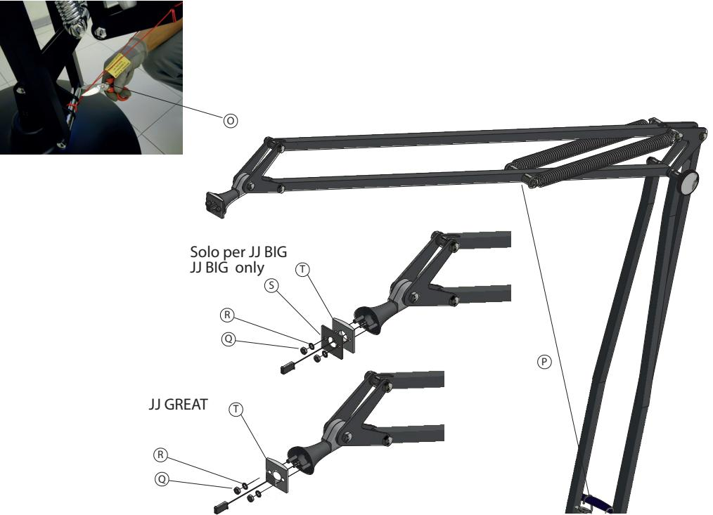
11 - Posizionare la calotta (V) in corrispondenza dei perni filettati (U). Far passare attraverso il foro centrale il cavo con il connettore (Z) e fissare il tutto seguendo la sequenza (T) - (S) Solo per JJ BIG - (R) - (Q).
