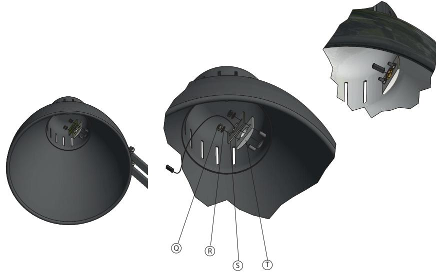
12 - Posizionare la calotta (V) in corrispondenza dei perni filettati (U). Far passare attraverso il foro centrale il cavo con il connettore (Z) e fissare il tutto seguendo la sequenza (T) - (S) - (R) - (Q).
