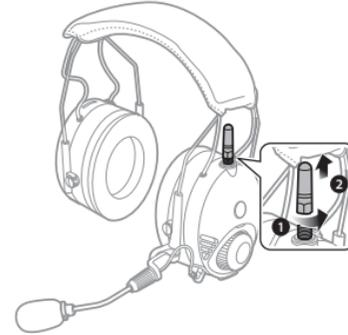
2. Bringen Sie anschließend die Langantenne an, und drehen Sie sie fest.
