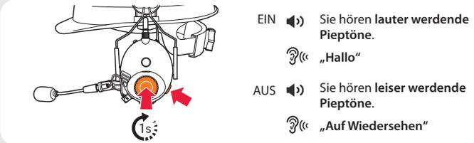
Halten Sie zum Ein- und Ausschalten des Headsets gleichzeitig den Drehknopf und die Telefontaste 1 Sekunde lang gedrückt.
