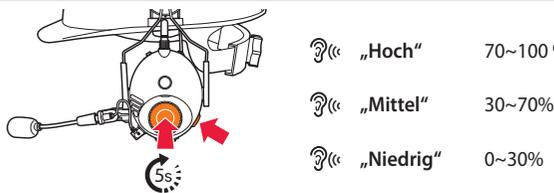
Oder halten Sie beim Einschalten des Headsets den Drehknopf und die Telefontaste für mindestens 5 Sekunden gedrückt. Sie hören einen Dreifach-Piepton und eine Sprachansage.
