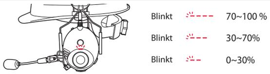
Schalten Sie das Headset ein und überprüfen Sie den Akkuladestand mit der Status-LED.
