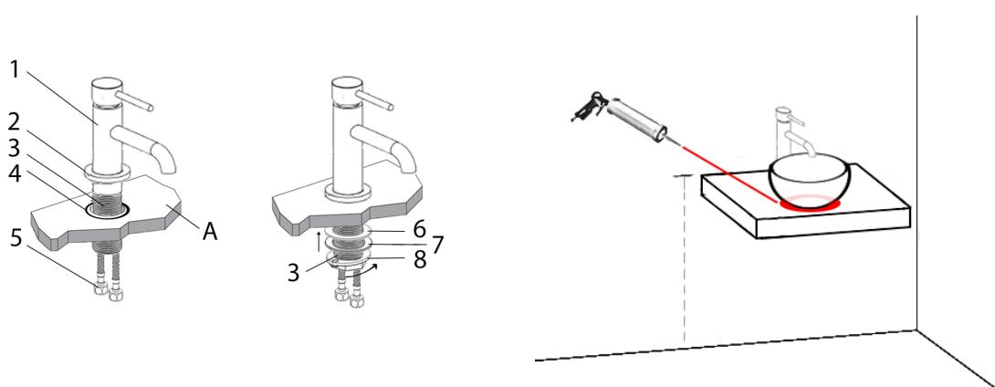
5- Seguire le istruzioni di installazione del vostro rubinetto e installarlo.
