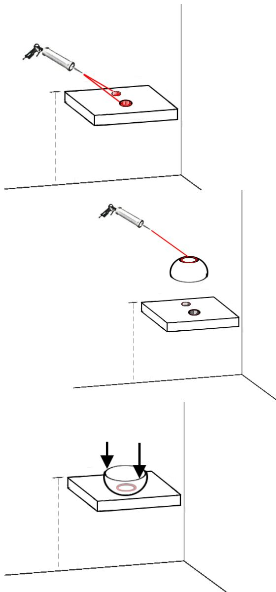
3- Verificare che la piletta (2) attraversi bene il lavabo (A) e il piano (B), e che possa essere serrata con il dado di serraggio (4) senza dimenticare le guarnizioni (1 e 3).
