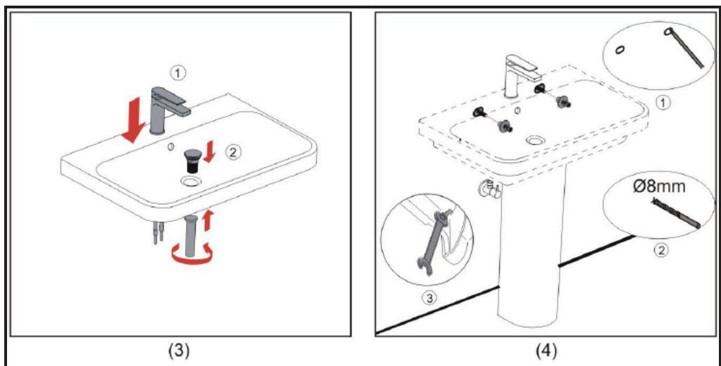
Collegare il sifone allo scarico. Verificare l'assenza di perdite nella vostra installazione. Ripetere l'installazione se necessario.
