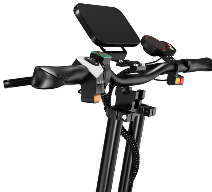
3. Serrez les vis du commutateur des phares, du verrouillage de tension et du tableau de bord.
