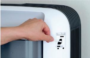
2. Trocknen Sie den Sensor mit einem trockenen Wattestäbchen.
