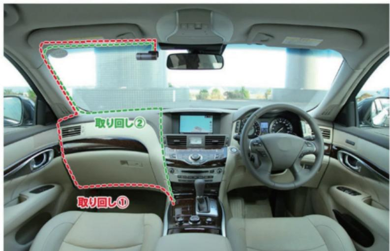
ステップ2：カメラを固定し、車内に沿ってケーブル接続を隠します。信号線（赤線）を反転させ、USBリアでレンズ接続線を引きます。
