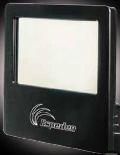
Espedeo PM-2000Aは、デジタルシネマプロジェクター用に開発されたスタンドアロンの3D偏光システムで、1眼あたり毎秒48フレームおよび60フレームの高フレームレート(HFR)コンテンツをサポートします。PM-2000Aには複数のコーティングが施され、通過する光の極性を正確かつ効率的に変化させてゴーストを排除することにより、明るく鮮明な画像を投影するのに役立ちます。PM-2000Aは、2Dおよび3D信号を検出することで簡単に操作できるように設計されており、システムは対応する作業位置を自動的にシフトできます。
