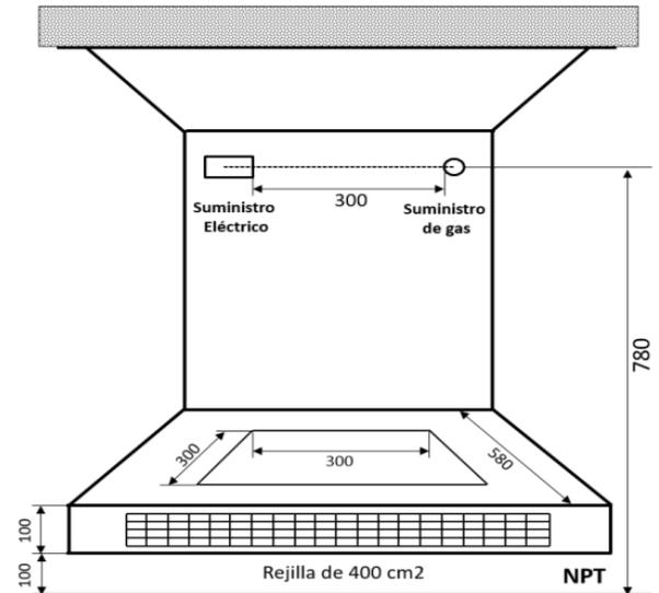
**I. Eléctrico****Suministro:** Circuito de tomacorrientes**Tensión:** 220 V / 60 Hz**Tipo:** Monofásico**Protección:** Sistema de puesta a tierra**Conexión:** Tomacorriente 2P+T**- Tipo de gas:** GN**Presión (mbar):** 16-19**II. Encastre (Embutido)****Ancho:** 600 mm**Profundidad:** 580 mm**Altura:** 600 mm**III. Encastre (Traslapado)****Ancho:** 560 mm**Profundidad:** 560 mm**Altura:** 580 mm**Importante:**
