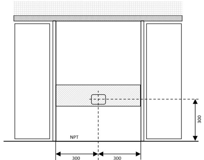
**I. Eléctrico****Suministro:** Circuito Independiente**Tensión:** 220 V / 60 Hz**Tipo:** Monofásico**Protección:** Sistema de puesta a tierra**Conexión:** Directa
