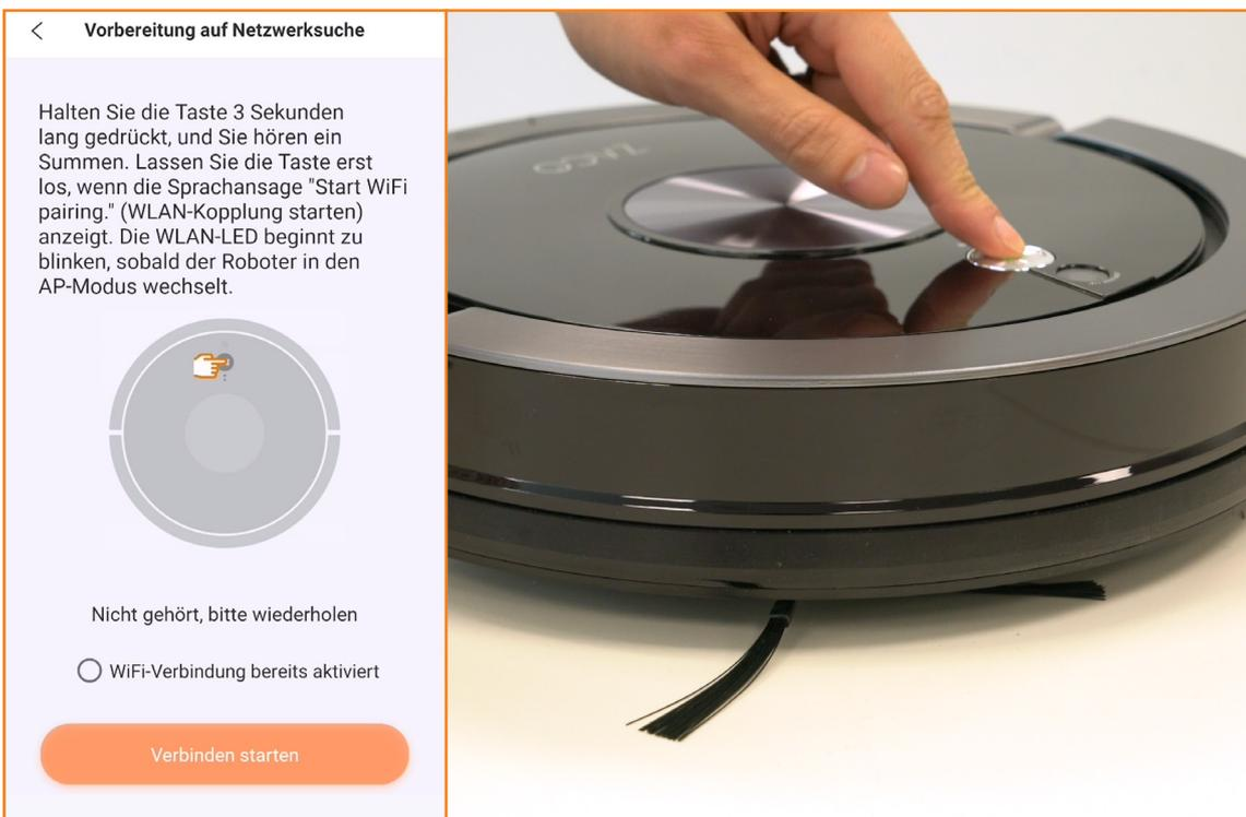
Sobald der Roboter vollständig hochgefahren ist, informiert dich die Sprachassistent darüber. Jetzt drücke bitte die Starttaste auf dem Roboter für 3 Sekunden.
