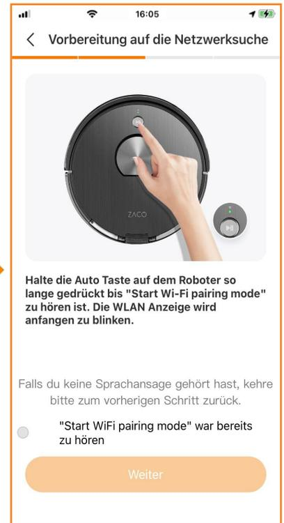
Klicke auf den Auto-Knopf auf deinem Roboter und halte diesen so lange gedrückt, bis Du "Start Wi-Fi pairing mode" hörst. Die WLAN Anzeige beginnt nun zu blinken.
