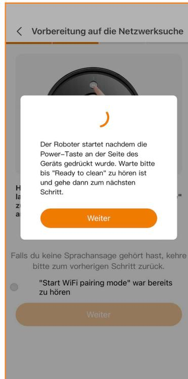
Ca. 20 Sekunden nach dem Einschalten des Roboters hörst Du die Sprachansage "ready to clean". Bestätige, dass Du die Sprachansage gehört hast, bevor Du fortfährst.
