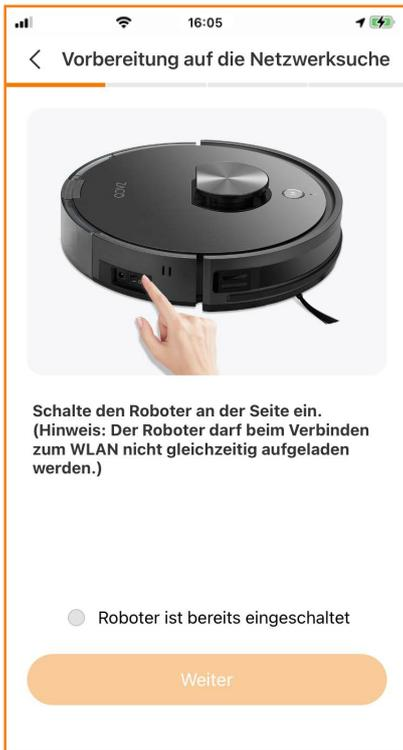
Damit Du deinen Roboter mit dem WLAN verbinden kannst, schalte ihn am Kippschalter an. Beachte, dass dieser bei der WLAN Kopplung NICHT im Lademodus sein darf.
