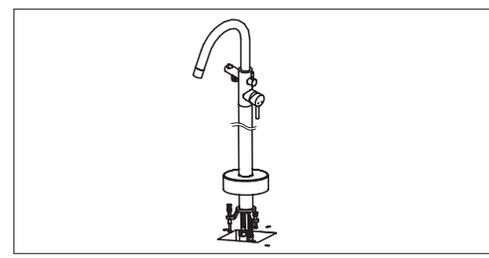
6. Insérez les boulons de fixation et fixez-les fermement dans le sol. Déplacez le couvercle pour masquer la base.
