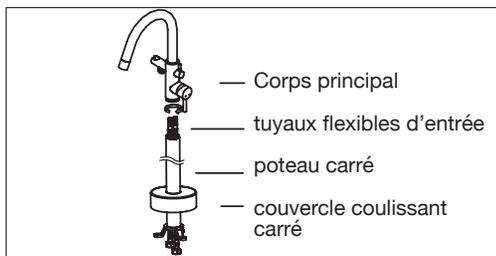
1. Insérez les tuyaux flexibles à travers le poteau carré et assemblez-les au corps principal en les tournant à la main.
