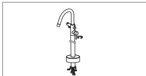
2. Faites correspondre le poteau carré avec le corps principal, fixez ensemble en tournant les 2 vis à l'arrière avec la clé.
