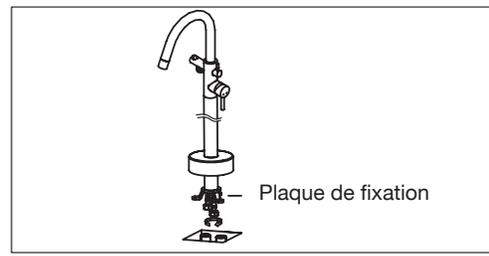
4. Insérez le couvercle coulissant sur le poteau carré, insérez les écrous du tuyau flexible, jetez la base de fixation et connectez les écrous G 1/2 avec les connecteurs du filet d'eau en fixant fermement par la clé.
