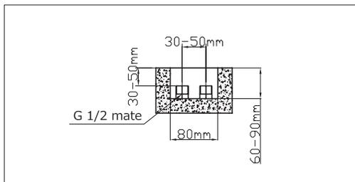
3. Créez une chambre dans le sol en suivant la mesure ci-dessus avec des connecteurs mâles G 1/2 pour filet d'eau.
