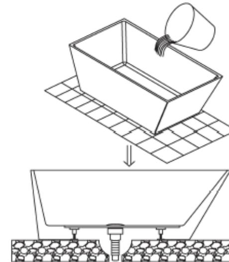
5. Appliquer une épaisse couche de silicone dans le contour du bain et laisser durcir 24 heures. Ce guide d'installation, l'installation de la sortie d'eau et la connexion ne doit être effectuée que par une personne qualifiée.
