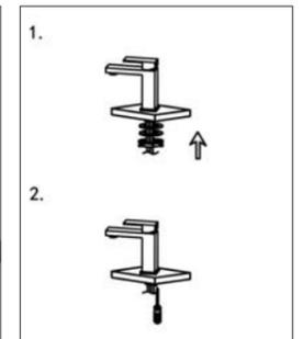
4. Réinstaller la rondelle en caoutchouc suivie de la rondelle métallique et du contre-écrou. Serrer à la main puis resserrer davantage à l'aide d'un tournevis pour serrer les vis du contre-écrou.
