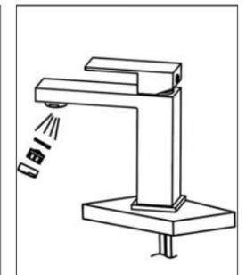
6. Retirez l'aérateur et ouvrez le robinet pendant 1 minute pour éliminer les débris du robinet et des conduits d'alimentation. Fermez le robinet et réinstallez l'aérateur.
