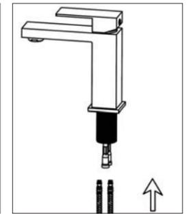
2. Vissez et serrez à la main les tuyaux flexibles chauds et froids au robinet. N'UTILISEZ PAS de clé pour serrer les tuyaux car cela pourrait endommager le tuyau et/ou le filetage du tuyau.
