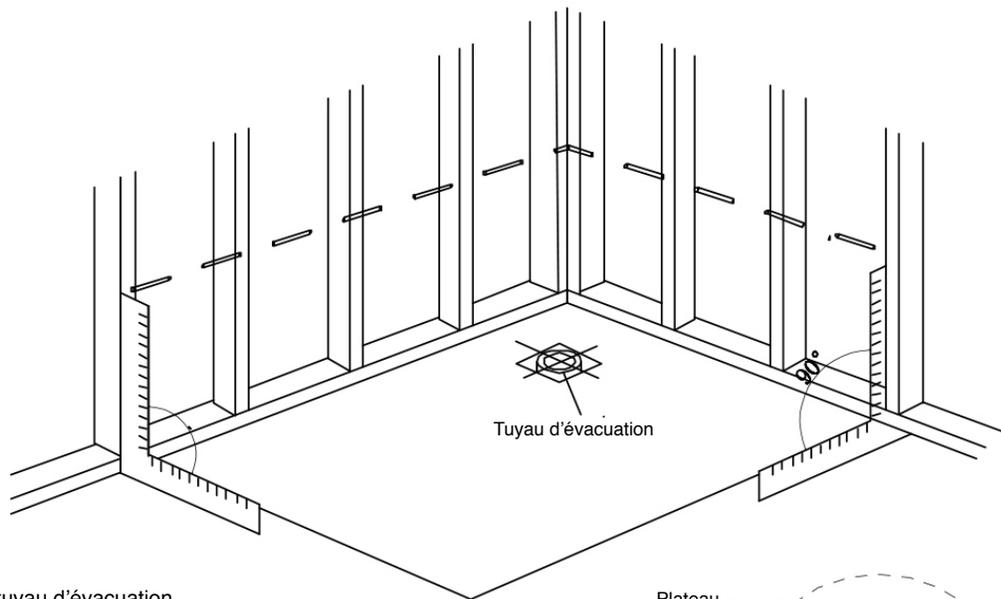
Placez le tuyau dans le tuyau d'évacuation
