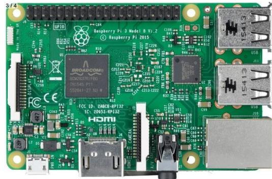
Abbildung 18; Raspberry PI 3 Model B
