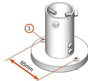
Abbildung 5; pi4 Tischbefestigung für Roboterkopf
