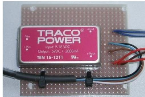
Abbildung 19; DC/DC Platine
