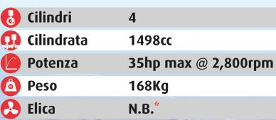
Possiamo fornire un'indicazione per elica a 3 Pale RH basata su specifiche standard e riduzione 2:1. \*N.B. Per calcoli personalizzati sono necessari tutti i dati dell'imbarcazione.
