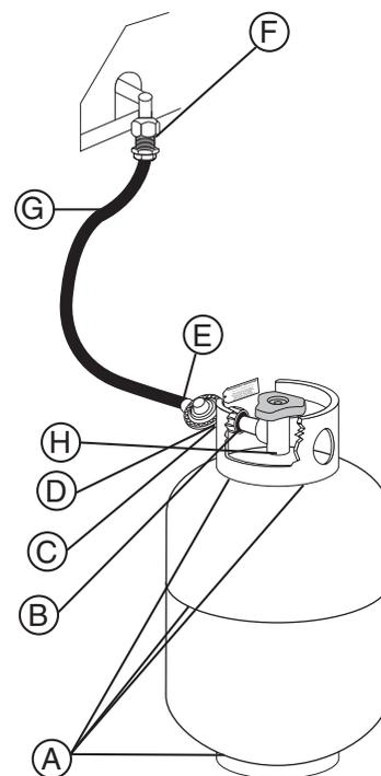
10. Resserrez toutes les connexions qui fuient. Si une fuite est détectée à l'écrou de raccord et si resserrer l'écrou de raccord n'arrête pas la fuite, vérifiez de nouveau le joint d'étanchéité du réservoir de propane. (Consultez la page 7)
