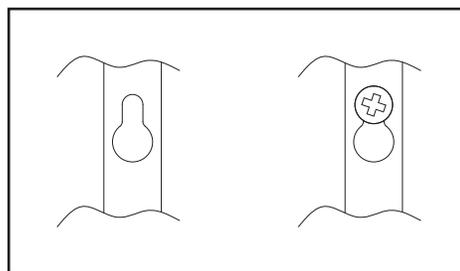
**NOTE:** Avant de serrer les vis en trou de serrure, assurez-vous que les panneaux sont alignés.
