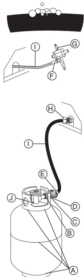
10. Resserrez toutes les connexions qui fuient. Si une fuite est détectée à l'écrou de raccord et si resserrer l'écrou de raccord n'arrête pas la fuite, vérifiez de nouveau le joint d'étanchéité du réservoir de propane. (Consultez la page 7)
