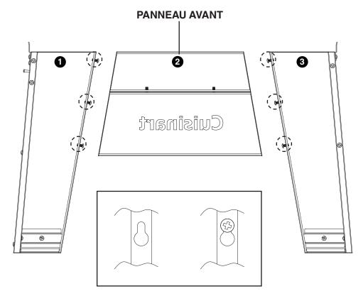
NOTE: Avant de serrer les vis en trou de serrure, assurez-vous que les panneaux sont alignés.
