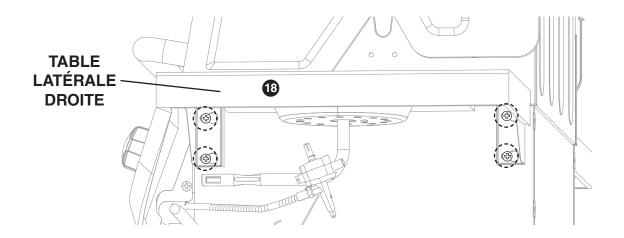
Installez la vis et serrez (la vis a été retirée en Étape 12)
