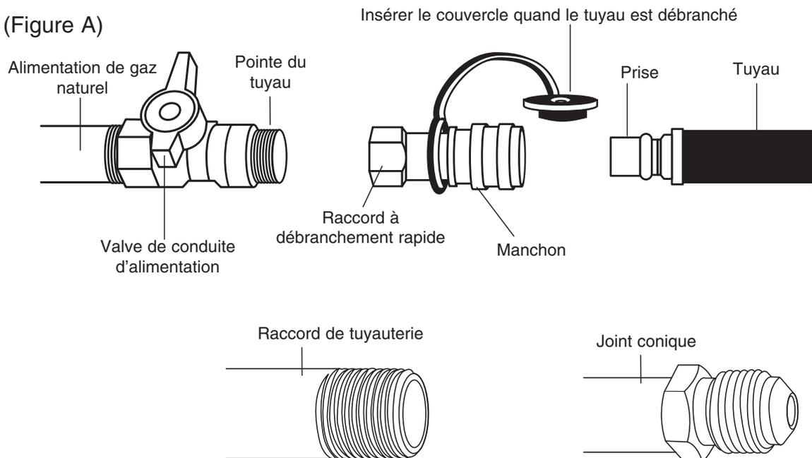
Utilisez le raccord de tuyauterie pour raccorder la fixation rapide à la conduite d'alimentation de gaz naturel. **NE PAS** utiliser le joint conique.
