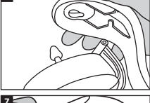
6. יש ליישר את החרוץ שבדיית מול הקנה ולחנוך את הדיית למטה בעדינות. יש לחנוך עד ששומעים קוליק.
