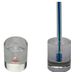
超微量サンプルバイアルで 15µL のサンプル測定
