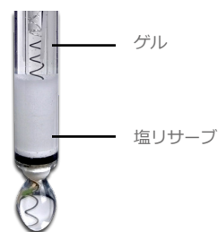
塩リザーブ付の pH 電極が低導電率溶液におけるドリフト
