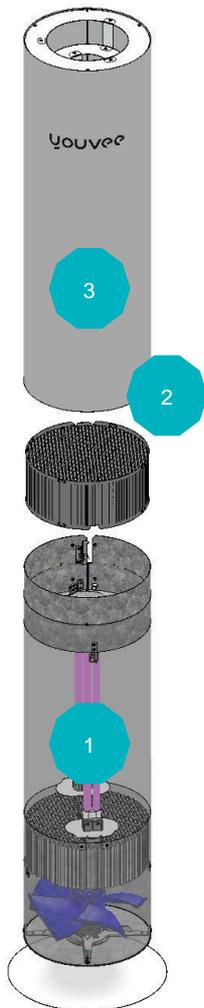
Bei Anlieferung ist der youvee® Luftreiniger nahezu vollständig vormontiert. Lediglich die obere- und untere Röhrenhälfte müssen wie folgt miteinander montiert werden.
