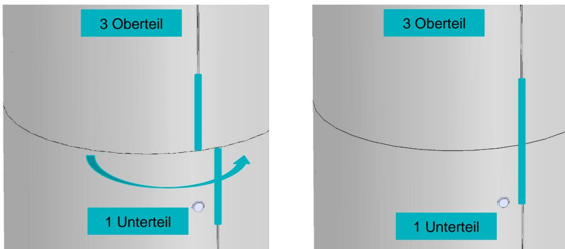
Abbildung 3: Montageschritt 4 – Installation und Verriegelung des Oberteils
