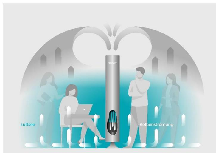
Abbildung 2: Luftströmung des youvee® Luftreinigers
