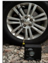
3. Appuyez sur le levier pour fixer le tuyau sur le pneu
