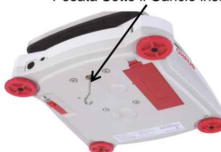
Pesata Sotto il Gancio installato
