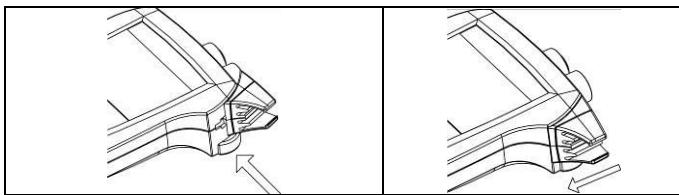
El soporte de electrodo es un soporte que se puede colocar junto a la pantalla en cualquier lado de la carcasa.
