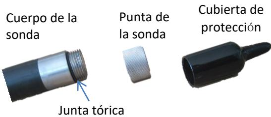
Presione el botón **Read Auto**, el botón **Cal** y el botón **Setup** al mismo tiempo para entrar a la pantalla de ajuste del parámetro de la nueva punta de sonda. Introduzca el parámetro de la nueva punta. Luego realice la calibración antes de efectuar cualquier medición.
