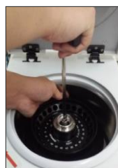
使用配有的工具固定转子
