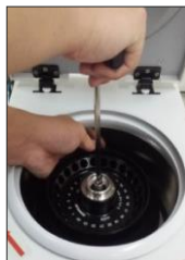
Szerszám rotorhoz csavaranya nélkül
