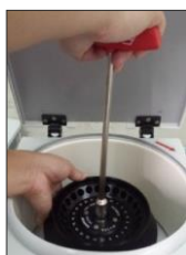
使用配有的工具固定转子
