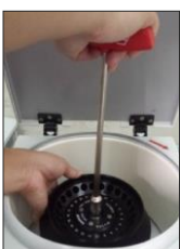
Ferramenta para o rotor com porca
