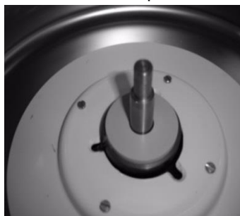
Eje del motor y cámara
