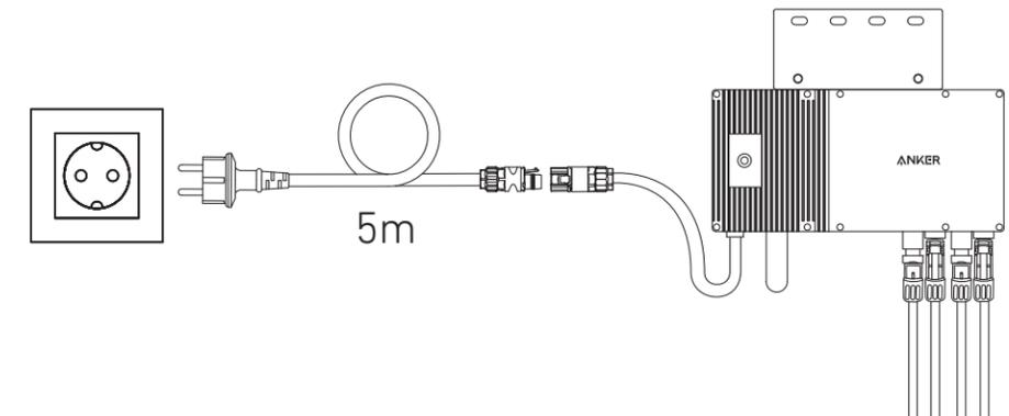
11. Laden Sie die App herunter und befolgen Sie die Anweisungen in der App, um die Konfiguration des Mikrowechselrichters und den Anschluss des Schuko-Kabels abzuschließen.
