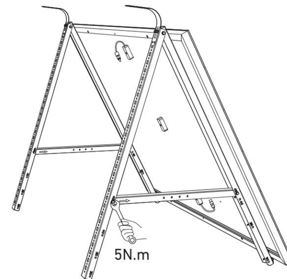
7. Verbinden Sie das Solarpanel mit dem Verlängerungskabel des Solarpanels.
