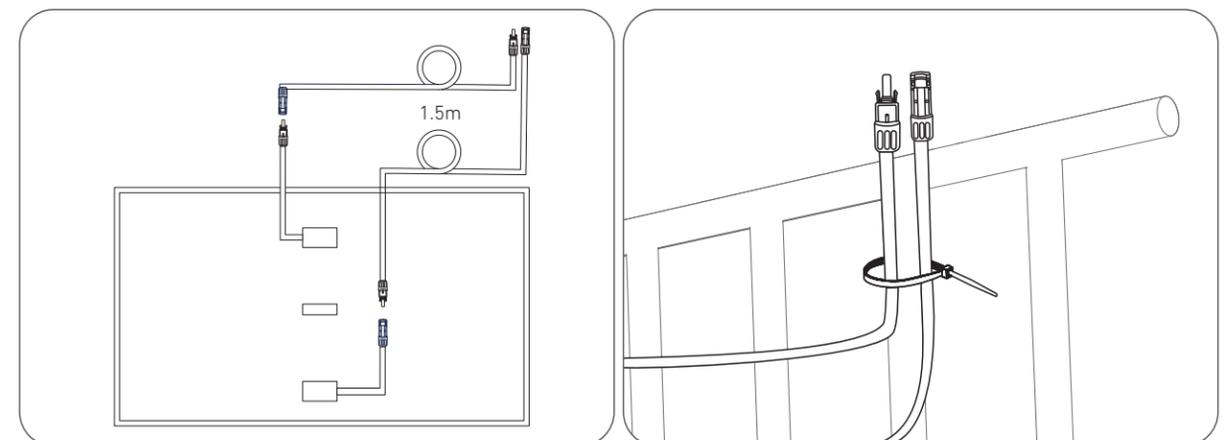
5. Befestigen Sie das Montagehilfsseil an der Halterung und am Balkongeländer. Stellen Sie sicher, dass das Seil straff gespannt ist.
