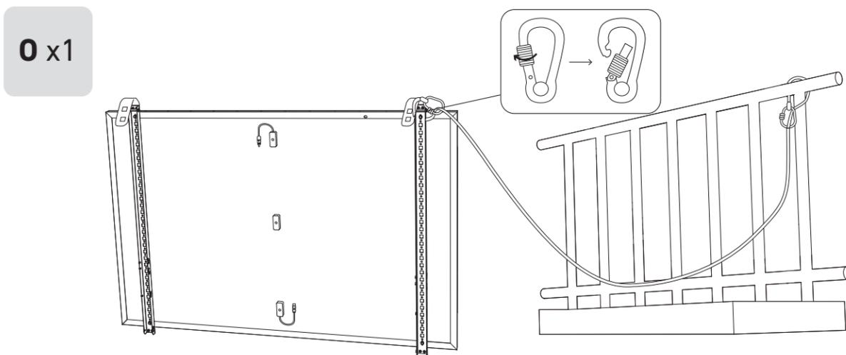
7. Hängen Sie das Solarpanel an das Balkongeländer und passen Sie die U-förmigen Träger manuell an die Form des Balkongeländers an. Sichern Sie dann die U-förmigen Träger mit Edelstahl-Sechskantmutter mit Flansch.
