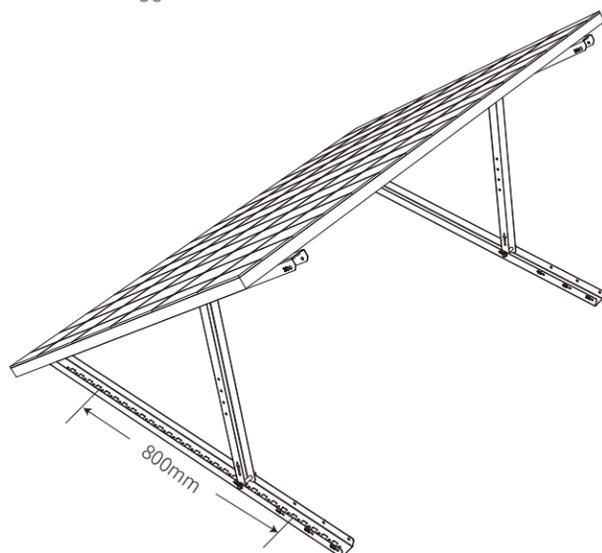
6. Entfernen Sie das Solarpanel, markieren Sie die Befestigungspunkte und bohren Sie die Löcher mit einer elektrischen Bohrmaschine 63 mm (2,4 Zoll) tief. Sichern Sie dann das Gerüst mit Muttern.
