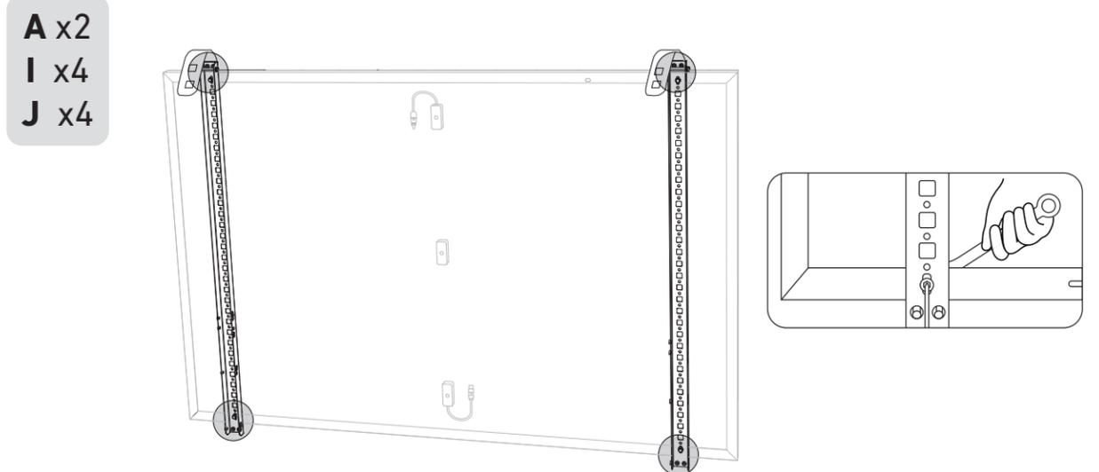
4. Ziehen Sie alle Schrauben mit einem Drehmoment von 5 Nm an.
