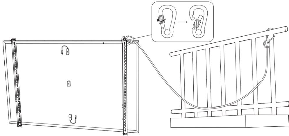
6. Bringen Sie die Halterungen für das Solarpanel am Balkongeländer an und befestigen Sie sie dann mit Befestigungsklemmen und Edelstahl-Sechskantmutter mit Flansch.
