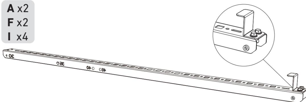
2. Montieren Sie die Solarpanel-Tragarme auf dem Solarpanel.
