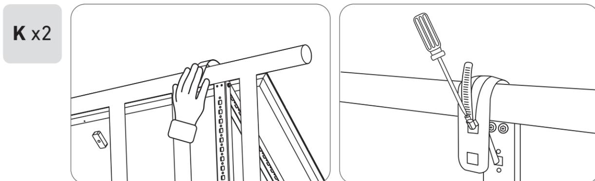
8. Bringen Sie die Halterungen für das Solarpanel am Balkongeländer an und befestigen Sie sie dann mit Befestigungsklemmen und Edelstahl-Sechskantmutter mit Flansch.
