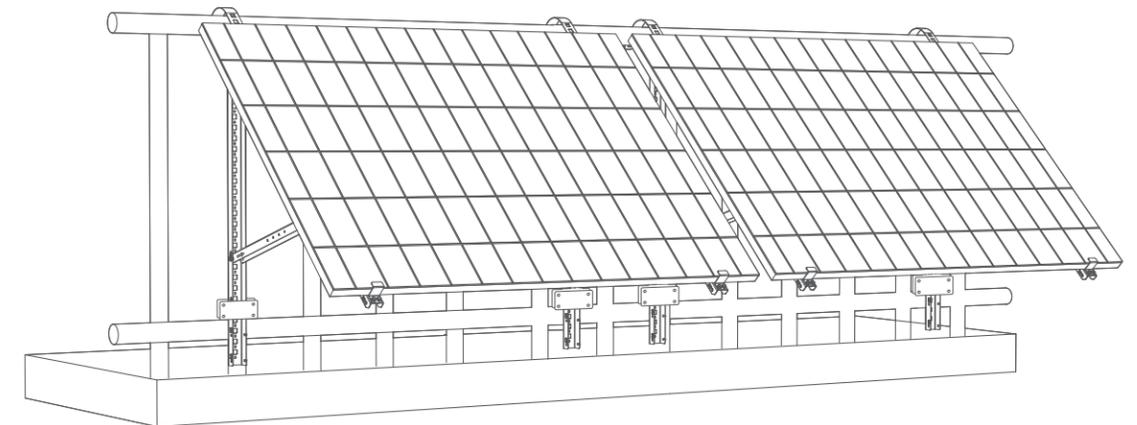
13. Verbinden Sie das Solarpanel und den Mikrowechselrichter mit den Verlängerungskabeln des Solarpanels. Warten Sie 90 Sekunden, wenn die LED-Anzeige zu blinken beginnt.
