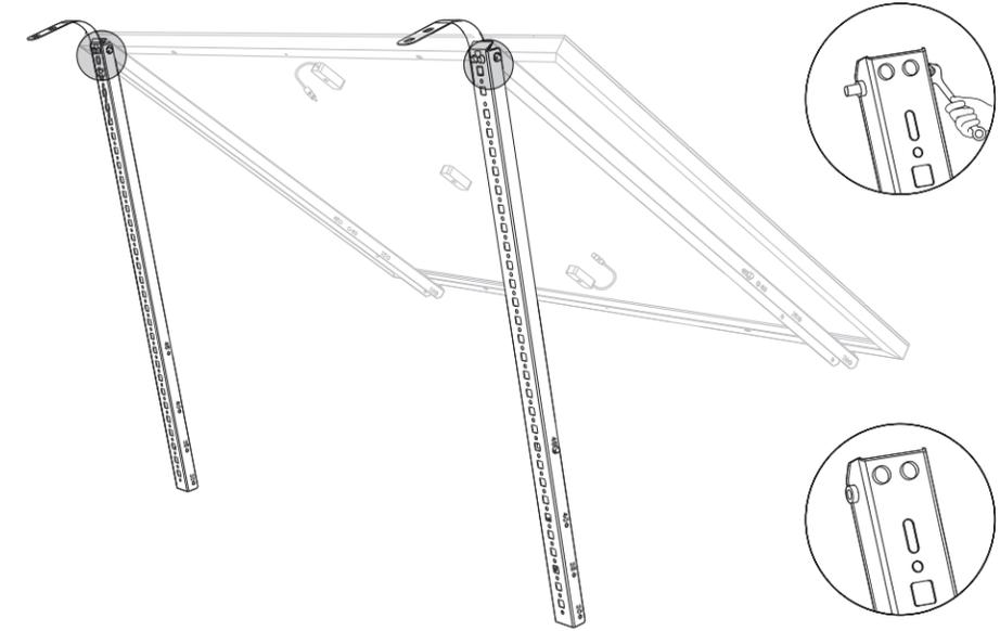
5. Montieren Sie den unteren Tragarm und stellen Sie den Winkel so ein, dass die maximale Sonneneinstrahlung erreicht wird.
