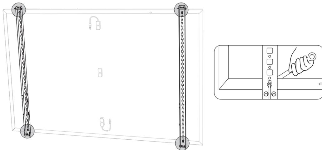
4. Montieren Sie das vertikale Gerüst und den Solarpanel-Tragarm, ohne die Schrauben festzuziehen.
