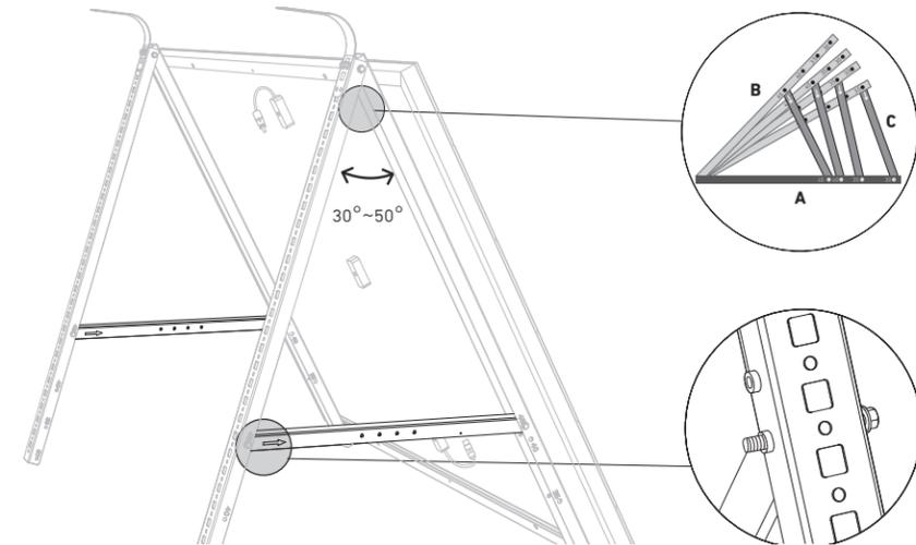
6. Ziehen Sie alle Schrauben mit einem Drehmoment von 5 N.m an.
