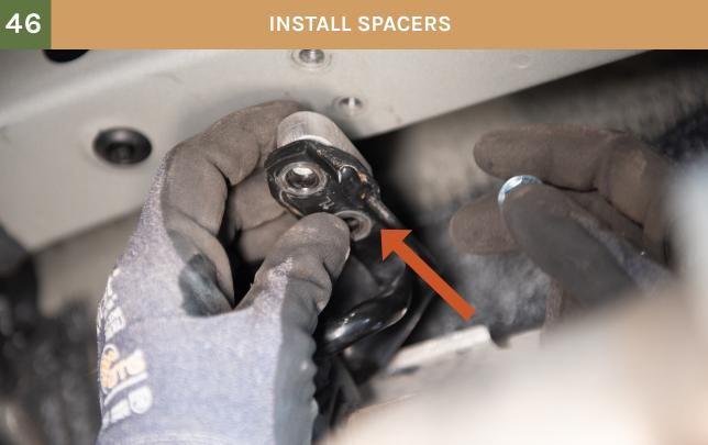
GAS MODELS: INSTALL THICKER SPACER ON LEFT SIDE BRACKET AND THE THINNER SPACER ON THE RIGHT SIDE BRACKET
