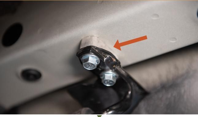
HYBRID MODELS: INSTALL BOTH SPACERS ON LEFT SIDE BRACKET AND NO SPACERS ON THE RIGHT SIDE BRACKET
