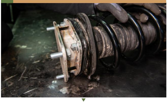
USE A PRY BAR TO HELP STABILIZE THE STRUT WHILE TIGHTENING
