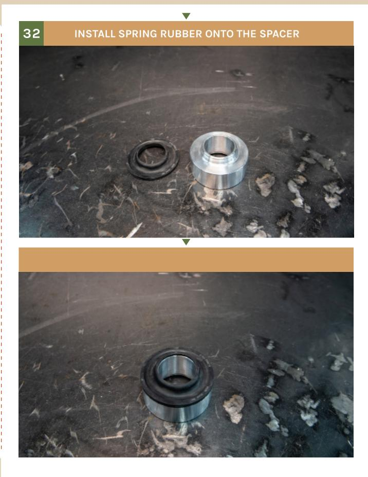
**INSTALL THE SPRING SPACER**
