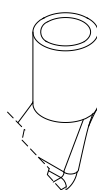
COLLETTO CHIUSO DA TUBO PIEGATO A 45^\circ O 90^\circ BARREL CLOSED BY A TUBE BENT AT 90^\circ OR 45^\circ
