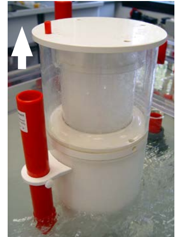
Düsenteil mit Luft- und Ozon-Anschluss
