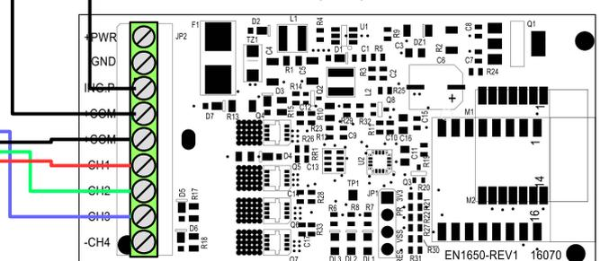
$$I_{CH1} + I_{CH2} + I_{CH3} = 5A \text{ MAX}$$
