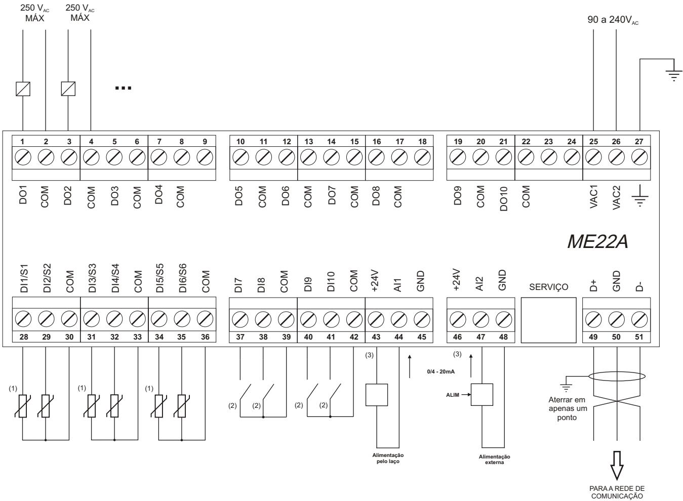
(1) As entradas DI<sub>n</sub>/Sn podem ser utilizadas como entradas digitais para contato seco ou para medição de temperatura com sensores NTC 10k, tipo III.
