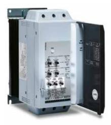
A série oferece fácil montagem em trilho DIN para potências até 30kW, controles de partida / parada de 2 fios ou 3 fios e função de partida de alta qualidade (4x In por 6 segundos).
