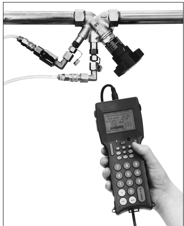
Aparelho de medição "OV-DMC2", nº do item 106 91 77 com "Hydrocontrol VTR"
