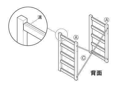
「棚板の入れ方」を参考に、下段から設置する®棚板を取り付けます。 ※収納する物の高さに応じて棚板の取り付け位置を決めてください。
