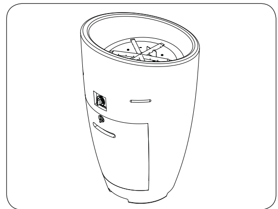
Fig. 17-3 Replace storage door
