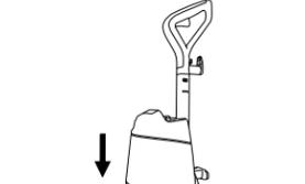
2 Alignez le réservoir et appuyez FERMEMENT sur le bouton-poussoir en place.
