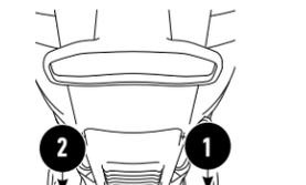
1 Appuyez sur la pédale de dégagement de la poignée avec le pied pour incliner l'appareil en position de nettoyage.
