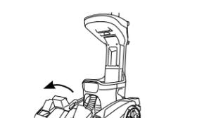
1 Retirez le couvercle de la buse en tirant vers le haut et vers l'avant sur le loquet.
