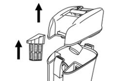
3 Déverrouillez le couvercle pour retirer le dessus. Retirez le panier du filtre et éliminez les débris. Videz le réservoir, rincez-le, et laissez-le sécher à l'air libre.
