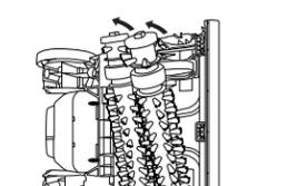
4 Tirez sur les deux rouleaux-brosses vers l'utilisateur pour les retirer de l'appareil. La courroie sera toujours fixée à l'appareil.
