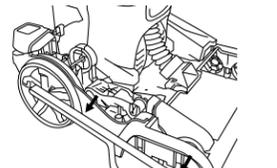
7 Faites glisser la courroie hors de son arbre pour la retirer. Si vous devez remplacer la courroie, installez-en une nouvelle.
