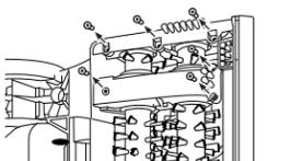
2 Retournez l'appareil sur le côté pour exposer le dessous.Pour enlever les couvercles de courroie, utilisez un tournevis Philips pour retirer les 6 vis. Les flèches indiquent l'emplacement des vis.
