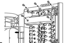
3 Remplacez les couvercles de courroie et fixez les 6 vis.
