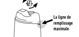
1 Soulevez pour retirer le réservoir d'eau propre, puis retirez le bouchon et ajoutez de l'eau chaude jusqu'à la ligne de remplissage. Ajoutez 3 oz de solution Hoover. Remettez le capuchon en place.
