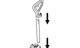
1 Insérez la poignée dans la base jusqu'à ce qu'un déclic se fasse entendre.
