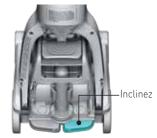
Branchez le cordon d'alimentation dans une prise de courant. Appuyez sur la pédale de dégagement de la poignée avec le pied pour incliner l'appareil en position de nettoyage.
