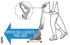
Poussez lentement vers l'avant puis tirez vers l'arrière tout en appuyant sur la gâchette pour appliquer l'eau et la solution de nettoyage.
