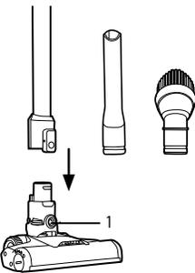
1 Appuyez sur le bouton de dégagement de la buse motorisée et tirez sur la buse motorisée pour la retirer du tube-rallonge.
