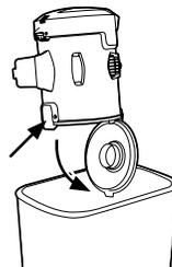
3 Placez le vide-poussière au-dessus d'une poubelle et appuyez sur le bouton de dégagement du vide-poussière pour le vider. Fermez le vide-poussière, puis remplacez-le en effectuant des mouvements de va-et-vient.
