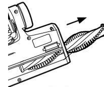
2 Tirez le rouleau-brosse hors de la buse motorisée. Pour enlever les fils ou les cheveux, faites glisser la lame d'une paire de ciseaux dans la rainure du rouleau-brosse et coupez le long de la rainure.
