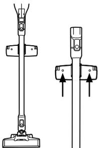
1 Choisissez l'emplacement souhaité, puis placez le support sur le mur à la hauteur voulue. Marquez les emplacements d'ancrage au mur. Installez les ancrages et vissez la fixation au mur.
