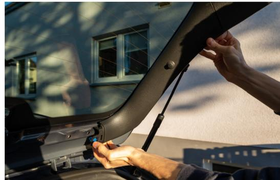
Das rechte und das linke Verkleidungsteil ebenso durch ziehen oder mit Hilfe von Zierleistenkeilen lösen.
