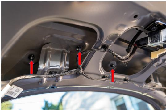
Die 7 gekennzeichneten 10mm Muttern lösen und entnehmen.
