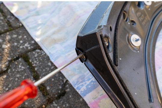
Mit einem Hebelwerkzeug nun die Klebeverbindung zwischen Heckspoiler und Heckklappenaufsatz auf beiden Seiten lösen.
