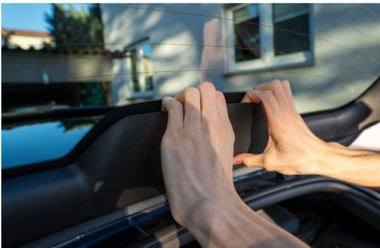
Das mittlere Verkleidungsteil durch ziehen oder mit Hilfe von Zierleistenkeilen lösen.
