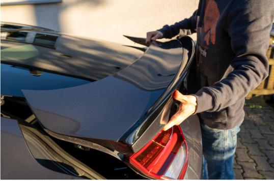
Nun kann der Heckklappenaufsatz komplett abgenommen werden. An diesem ist der originale Spoiler montiert.
