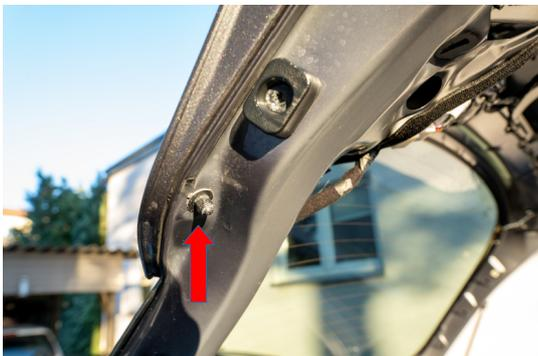
Äußere 10mm Mutter+Unterlegscheibe auf der rechten, sowie linken Fahrzeugseite, ebenfalls lösen und entnehmen.
