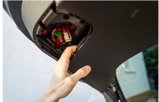
Nun durch ziehen oder mit Hilfe eines Zierleistenkeils das Hauptverkleidungsteil abnehmen
