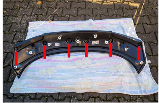
Die 6 markierten Muttern mit der 10mm Nuss lösen und entnehmen.
