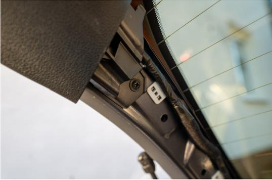
Die Kreuzschlitzschraube des Hauptabdeckungsteils auf beiden Seiten lösen und entfernen.
