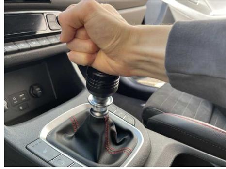
Den Schaltknopf mit der Aufnahme nun auf die Schaltstange aufsetzen und durch einen leichten Schlag bis zum Anschlag drücken.
