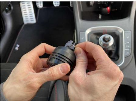
Den Sicherungsring in unseren Adapter einsetzen.
