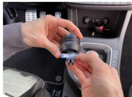
Den TGWorks Sticker von der Transferfolie abziehen und zur Sicherung des Rings auf den Adapter kleben.
