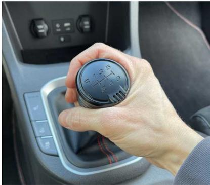
Sollte der Schaltknopf verdreht sein, kann er einfach durch drehen ausgerichtet werden, sodass er mit den Linien fluchtet.
