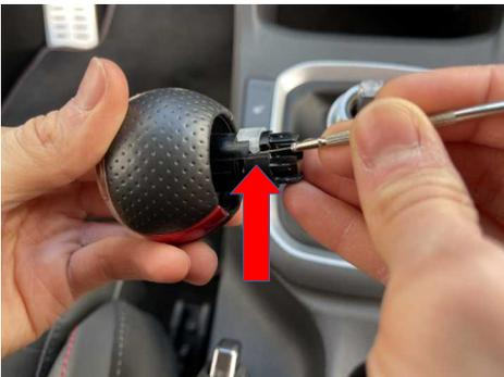
Mit Hilfe eines kleinen Schlitz-Schraubendrehers oder einer Nadel, den weißen Clip zur Sicherung des Sicherungsringes, auf beiden Seiten lösen.
