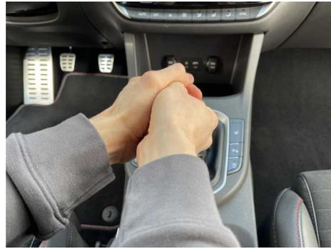
Den zweiten Gang einlegen und ruckartig fest nach oben an dem Schaltknauf ziehen.
