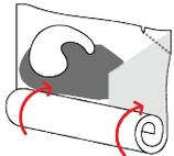
3. Nach Aufplatzen der Trennnaht, den Klebstoff durch das Aufrollen der Klebstoffkammer vollständig in die dünne Reaktionskammer drücken.
