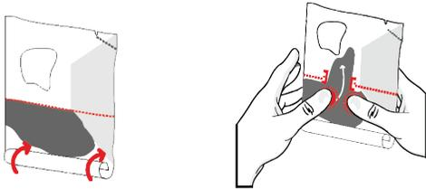
2. Mische den Spezialkleber an. Den unteren Rand der dicken Klebstoffkammer einmal umfalten und den Klebstoff mit beiden Daumen kräftig nach oben Richtung der dünnen Reaktionskammer drücken, so dass die Trennnaht in der Mitte aufplatzt.
