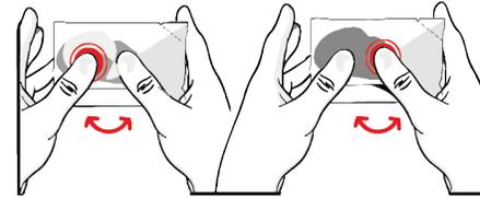
4. Den Klebstoff nun innerhalb dieser Kammer mit dem darin befindlichen Reaktionsmittel vermischen: Hierzu die Masse mit beiden Daumen mind. 20 Mal hin und her kneten, dabei keine Ecke auslassen.
